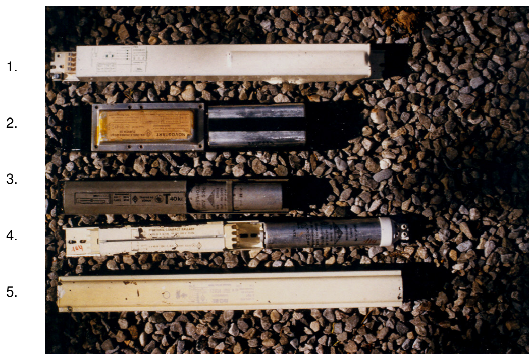
Abb. 2 Kapazitive Vorschaltgeräte von 5 verschiedenen Herstellern. Länge (oberstes Gerät) = 40,7 cm.
