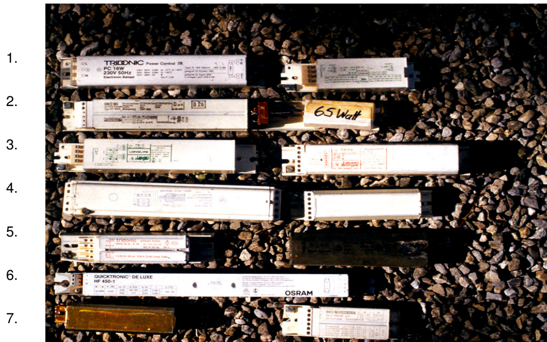
Abb. 3 Induktive Vorschaltgeräte (ohne Kondensatoren) aus den Jahren 1958 - 93. Länge (Gerät Nr. 6) = 35,5 cm.
