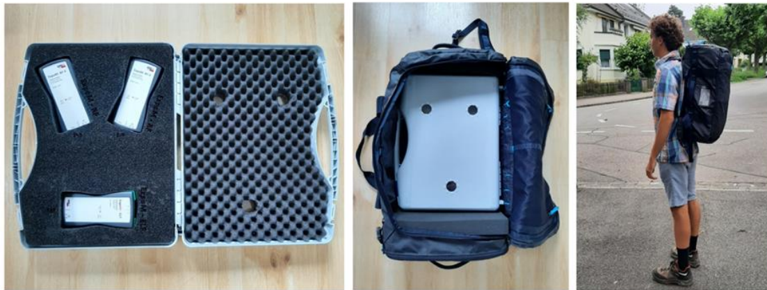
Abbildung 2: Darstellung des Setups für die Routenmessung. Links: Drei Messgeräte (zwei ExpoM-RF4 und ein ExpoM-ELF) sind in einem mit Schaumstoff gefüllten Koffer befestigt. Zentrum: Der Koffer wird in den Rucksack gestellt und mit Schaumstoff fixiert. Rechts: Die Messperson trägt den Rucksack mit den Messgeräten in einem Abstand von 20 cm zu ihrem Körper und in einer Höhe von 160 cm.
