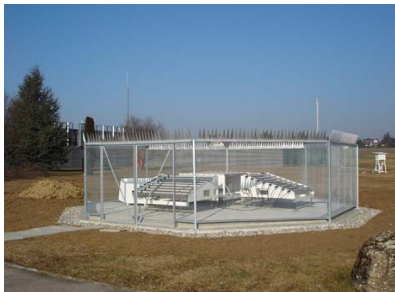
Darstellung B.8: «remote-sensing»-Messanlage für Wind- und Temperaturprofile am Standort Payerne (Bildquelle MeteoSchweiz)
