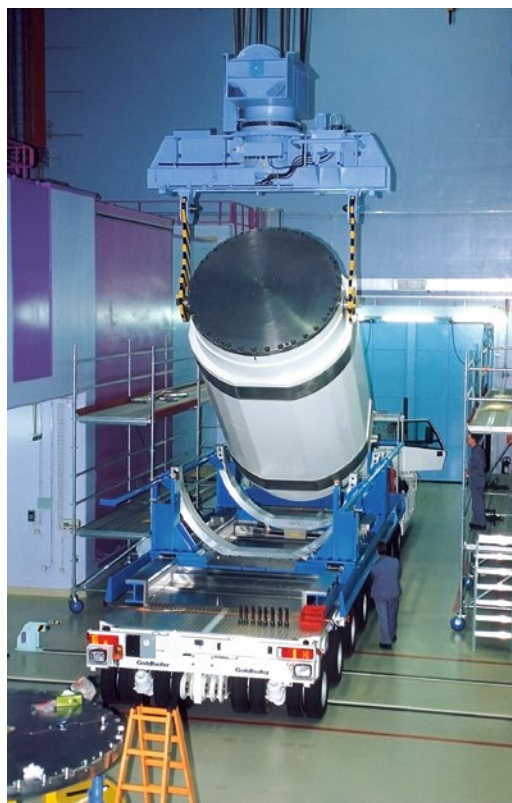
Empfang eines T/L-Behälters im Zwiilag. Foto: Zwiilag
