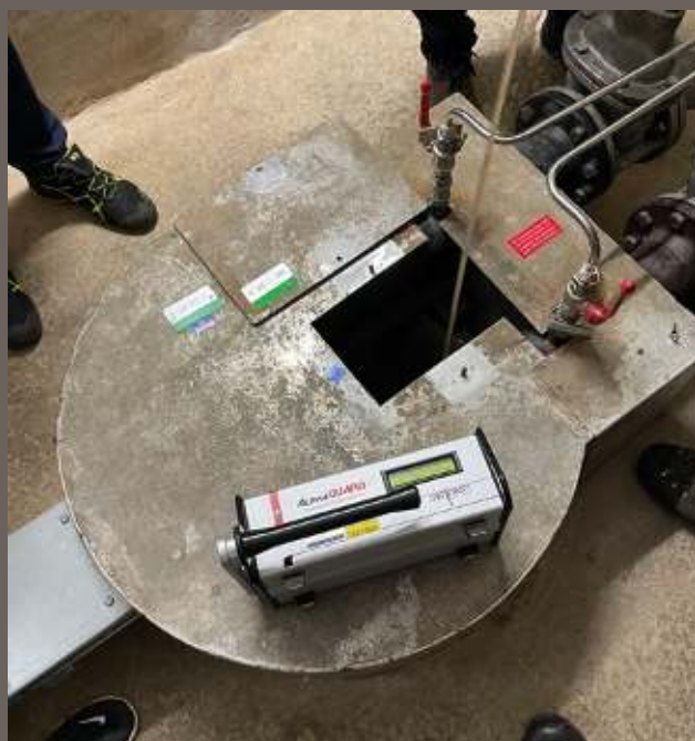
Bild 3: Radon-Screeningmessung bei der Brunnenöffnung für die Grundwasserfassung im KKB.
