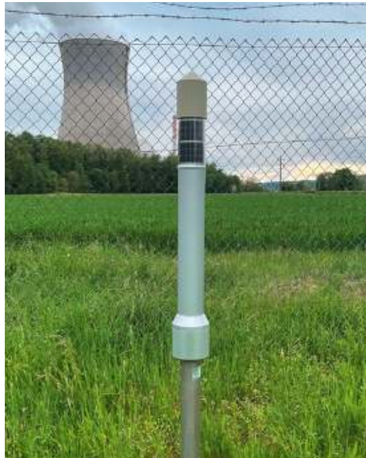
Bild 18: MADUK-Messsonde in der Nähe des KKL.
