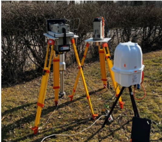
Bild 20: Vergleichsmessungen bei der Inbetriebnahme des neuen In-situ-Detektors.
