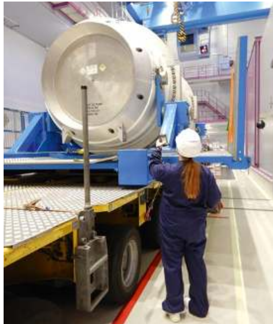
Bild 14: Dosisleistungsmessung an einem angelieferten Transportbehälter.
