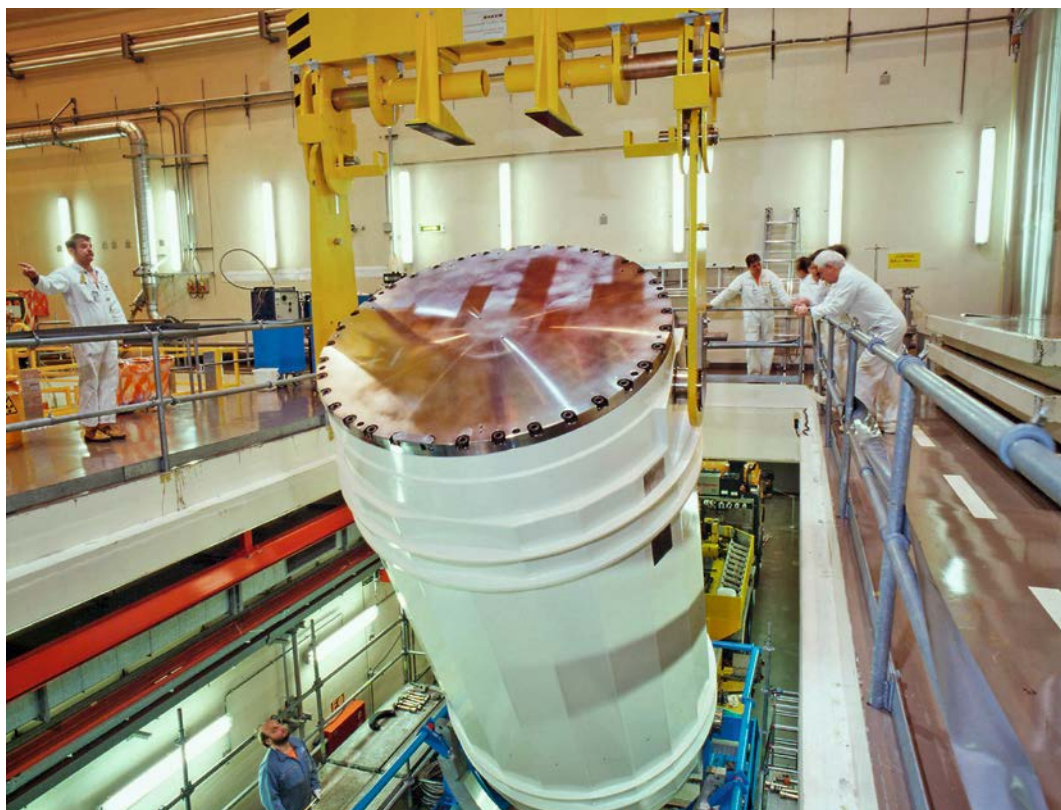
Umladen eines Transport- und Lagerbehälters. Foto: KKL
