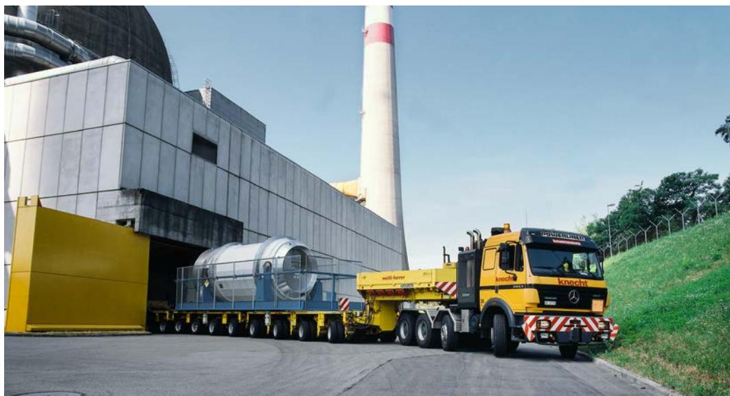
Abtransport eines Transport- und Lagerbehälters mit radioaktiven Abfällen. Foto: KKL
