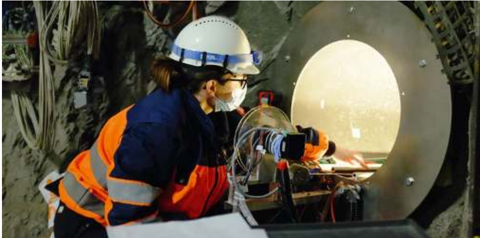
Photogrammetrie-Experiment im Felslabor Mont Terri. Foto: swisstopo
