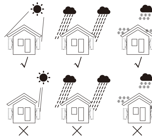
Rysunek 4.1 Zalecane miejsce instalacji
